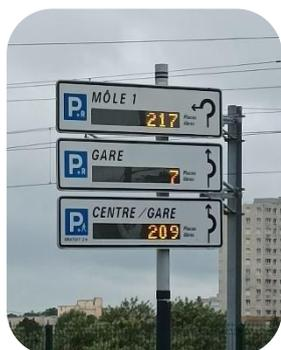
Un **système de jalonnement dynamique** a été mis en place à Dunkerque. La signalisation indique en temps réel aux automobilistes, l'occupation des parkings ainsi que le caractère payant ou gratuit. La réduction du temps de recherche d'une place qui en découle réduit ainsi le nombre de véhicules en stationnement.
