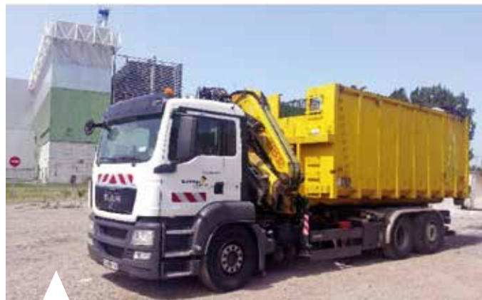
Camion-grue avec benne (collecte des PAV)
